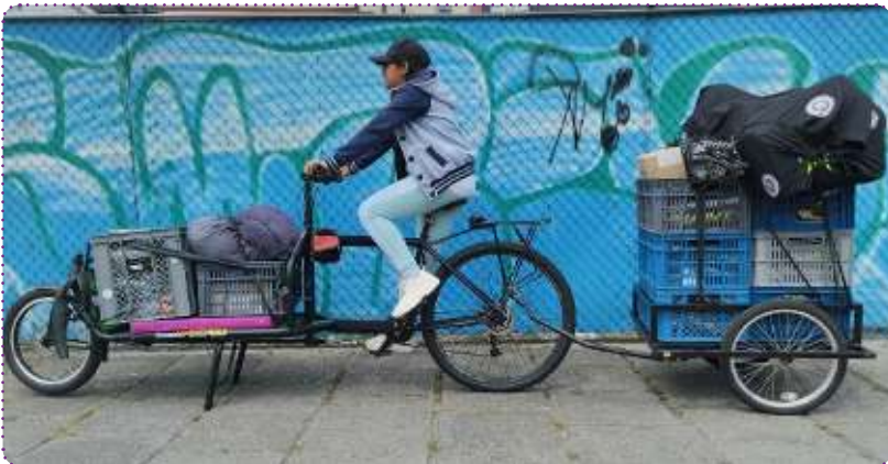
Fotografía 5. «Bicicargo» Prototipo de bicicleta de carga creado por el colectivo «Bogotá en Bici»
